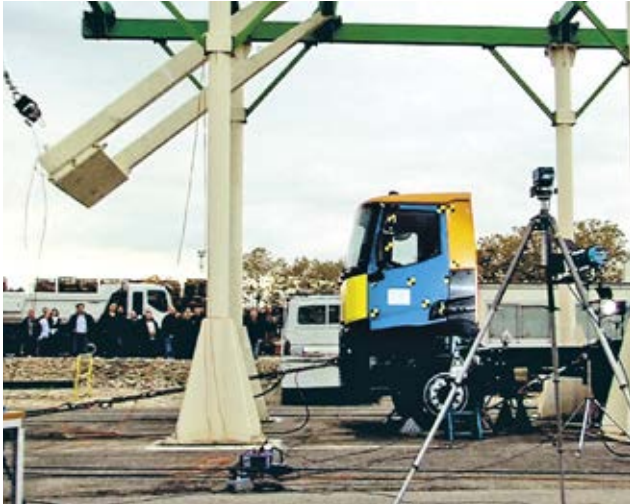
FONT IMPACT TEST om de sterkte van de cabine bij een frontale botsing te bepalen.
