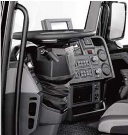
WEGKLAPBAAR STUUR “EASY ACCESS” om het in- en uitstappen te vereenvoudigen.
