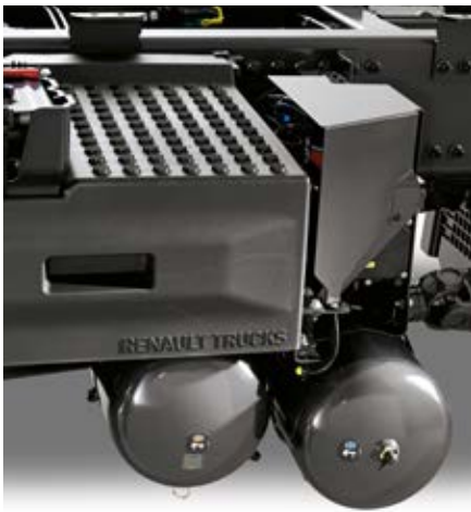
BESCHERMBEUGELS om de componenten die aan schokken worden blootgesteld extra te beschermen: EACU, pneumatische systemen.
