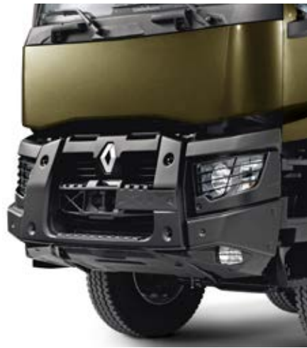
100% STALEN BUMPER standaard bestaande uit drie delen om de onderhoudskosten te beperken.
