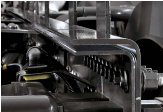
RUIM AANBOD AAN CHASSISVERSTEVIGINGEN VOOR DE LANGSLIGGERS om de mechanische sterkte van het frame af te stemmen op het gebruik.
