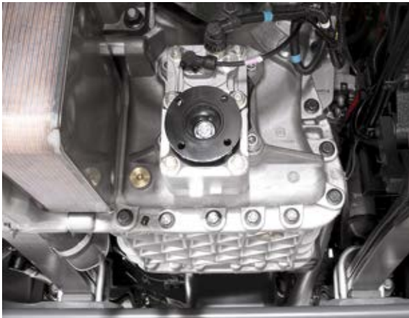
OPTIDRIVER XTREM Speciaal ontworpen voor gebruik in de mijnbouw, steengroeven en voor zwaar grondverzet: heeft een as met zes segmentvertandingen in plaats van vier, specifieke tandwielen en een schakelprogramma voor versnellingen dat zich aanpast aan de belading van het voertuig.
