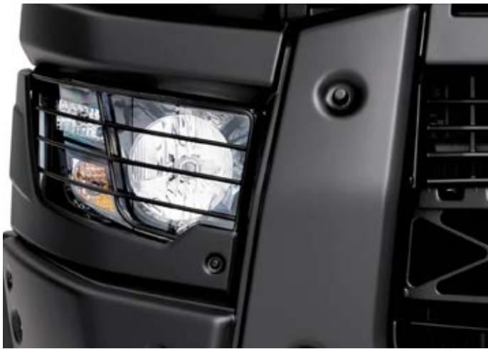
STANDAARD BESCHERMROOSTERS VOOR DE KOPLAMPEN en lampglazen van polycarbonaat die verdiept in de bumper zijn geplaatst voor een grotere schokbestendigheid.
