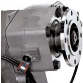
PTO om de uitrusting van de carrosseriebouwer aan te drijven, stilstaand of al rijdend.
